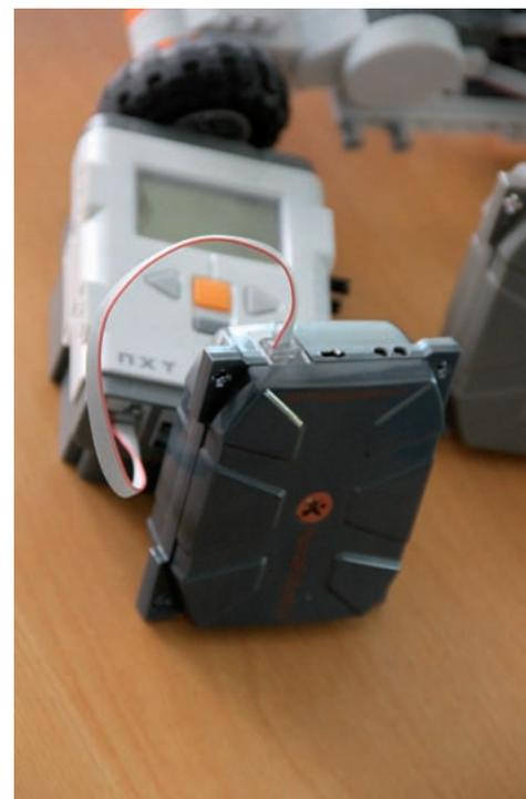
Un robot Lego Mindstorms NXT 2.0 équipé d'un WifiBlock. — Un WifiBlock connecté à la brique intelligente Lego.
