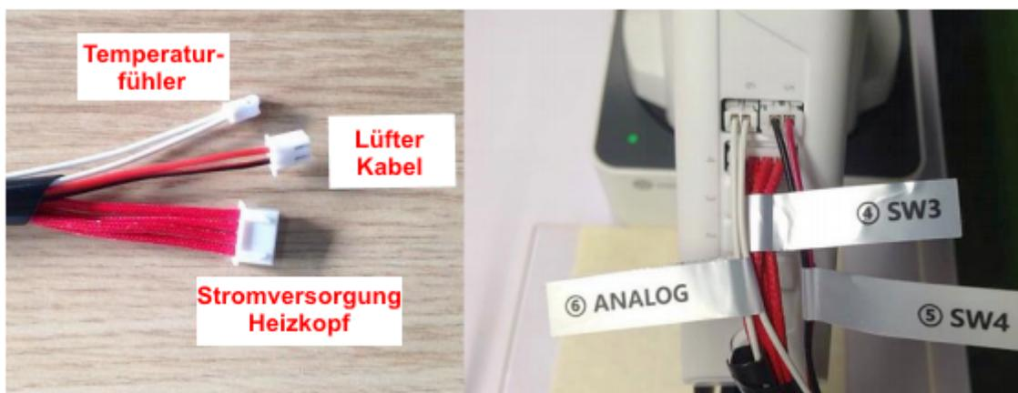
Schritt 6: Verbinden Sie den Extruder am Stepper 1 Kontakt an der Dobot Basis:
