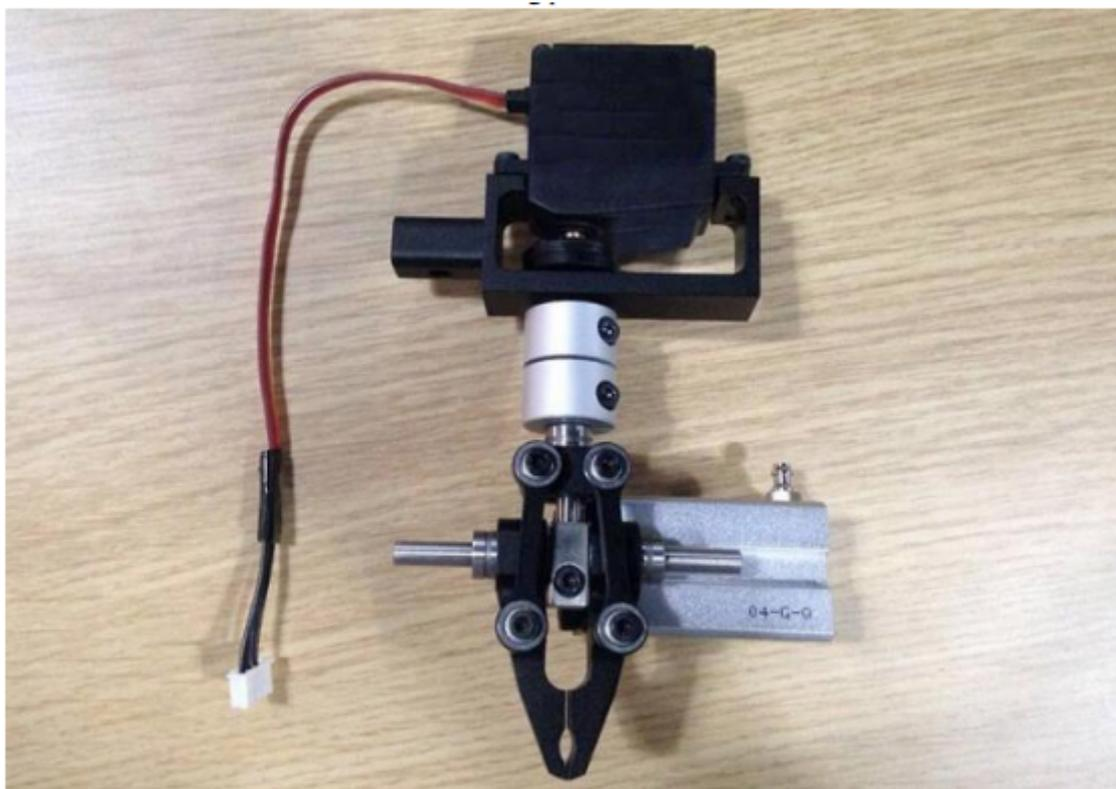
2. Auch der Greifer wird mittels der Pumpe betrieben. Daher muss der Saugkopf von dem Servo Joint4 abmontiert werden. Mit Hilfe des beiliegenden Sechskantschlüssels kann die mit folgenden Bild markierte Schraube lösen:
