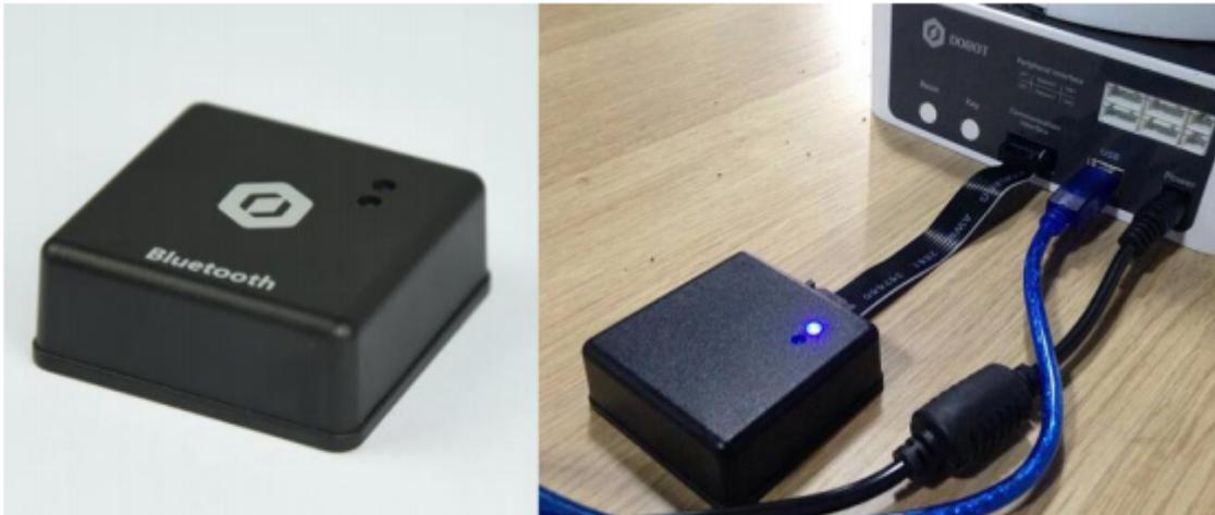
8.2 Nachdem das Modul angeschlossen wurde kann der Dobot eingeschaltet werden. Es sollte ein kurzer Signalton ertönen. Danach kann das Modul unter dem Namen BLE-100 gefunden werden und durch die Smartphone App verbunden werden.
