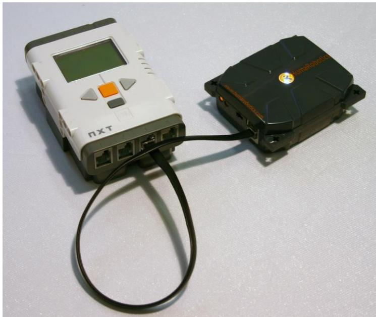
Figure 4: Connection entre la brique Lego Mindstorm et le WifiBlock
