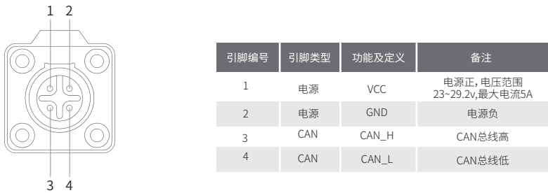
图 2.5 尾部航空接口引脚说明图
