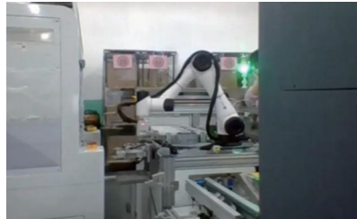
Beladen/Entladen der Klebespritzmaschine
