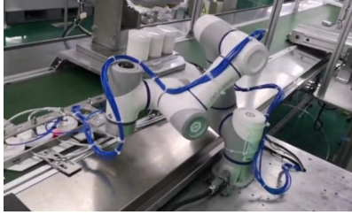
Carico/scarico coperchio in plastica
