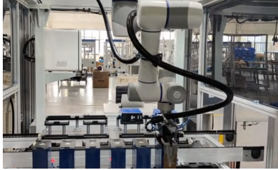
Carico/scarico del test della batteria
