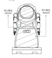
【步骤7】利用底部的扣手位,2-3人一起将机器从底座上抬出。
