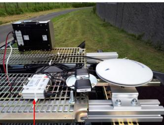
IMU + Antennes GPS
